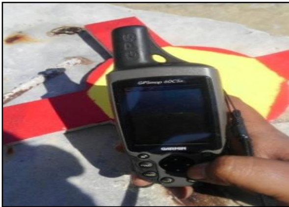
Gambar 2. Marking GCP dengan GPS
