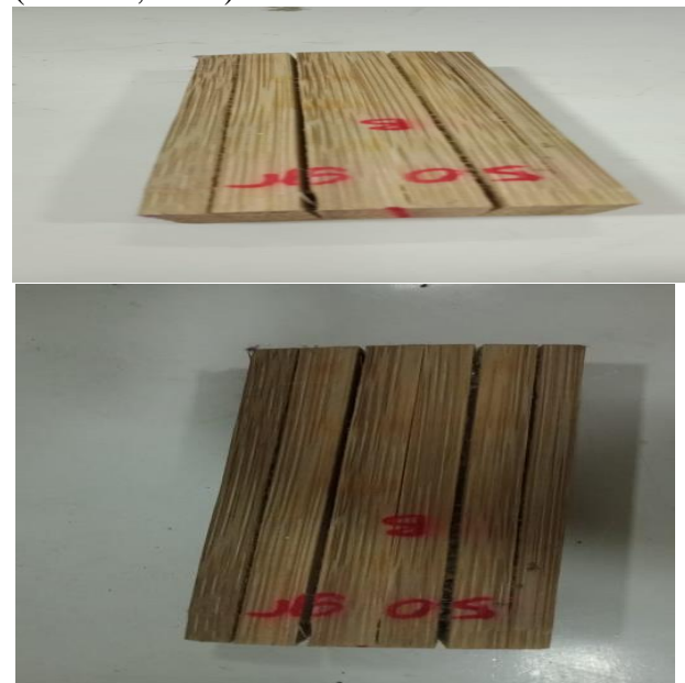
Gambar 1. Papan laminasi bambu petung mengalami peregangannya pada garis perekat setelah perendaman 24 jam
