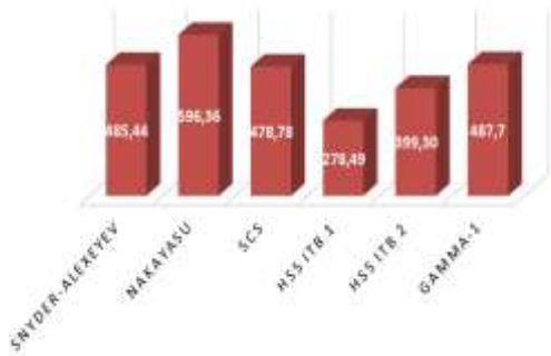
Gambar 5. Debit puncak PMF dari curah hujan PMP analisis frekuensi
